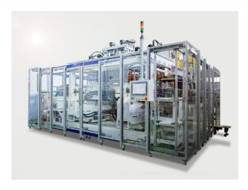
大ロット生産に対応した電動式汎用ブロー成形機を開発しました。新型締機構を採用し、型締時や打込時のプラテンのたわみを最小限に抑えるとともに、ベントストッパーが不要になりました。製品取出方向を従来の左右方向への取出しから後ろ方向の取出しに変更したことで、機械幅が従来よりも35%縮小しました。新構造ヘッドを搭載しており、1頭~12頭までのバリエーションに対応できるようになりました。
